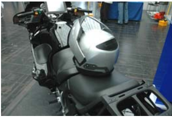
BMW-RT mit DeltaCar-PC & Motorradhelm mit Bluetooth-Freisprecheinricht. (je 2 Mikrofone & Lautsprecher im Helm integriert)
