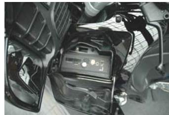
Einbau-Situation des DeltaCar-PCs im DIN-Schacht Gehäuse von Motorrad Typ BMW-RT
