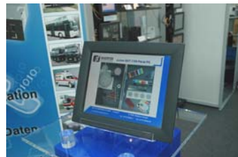
GOT Einbau-Panel-PC mit Aluminium-Magnesium-Gehäuse, TouchScreen-Oberfläche, IP65 wasserdicht
