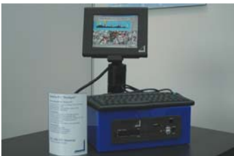
DeltaCar-PC mit 6,5" LCD-TFT-Monitor und einer Software-Navigationslösung (Moving Map) für General Aviation
